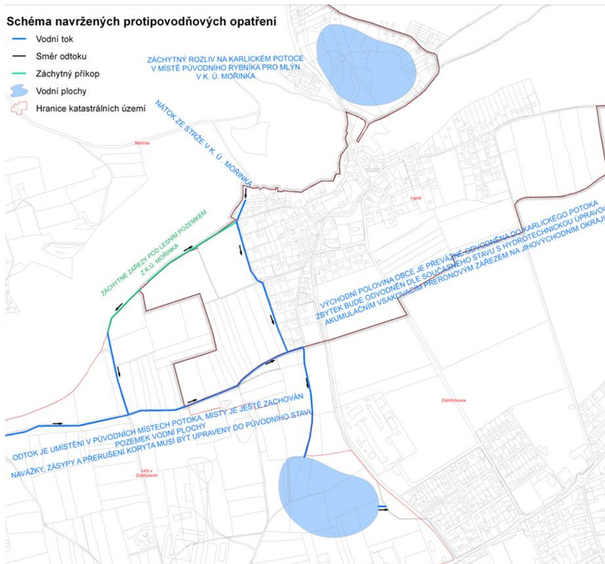
Obr. 2 Schéma navržených protipovodňových opatření v k.ú. Karlík a sousedních katastrech (převzato z textové části odůvodnění ÚP)
