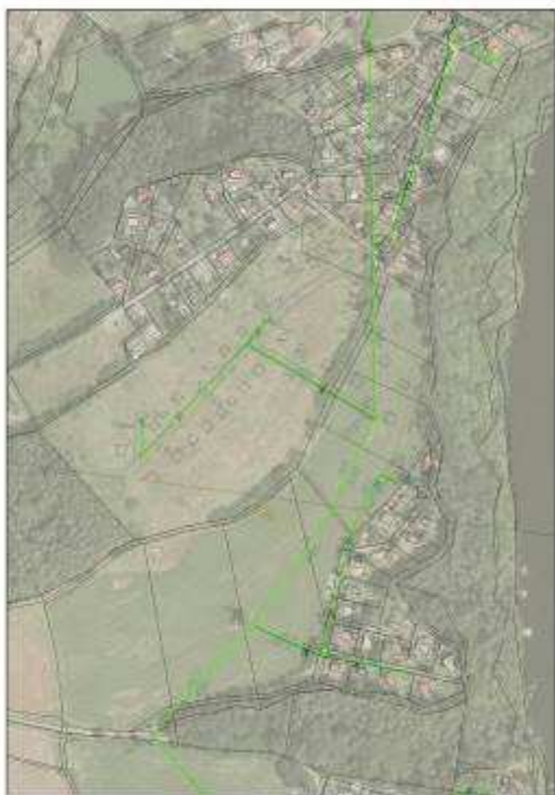
OBRÁZEK 13 VLEVO SOUTISK PODKLADU A ORTOFOTOMAPY S PŘEKRESLENÍM VODOVODU PŘED ÚPRAVOU, VPRAVO ČERVENĚ VYZNAČENÁ ÚPRAVA TRASY VODOVODU
