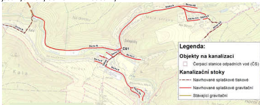
schéma řešení systému likvidace splaškových odpadních vod v Solopiskách a Kale
