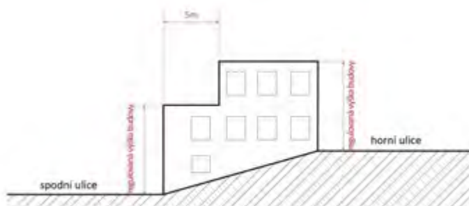
Obr 2. Stanovení výšky nezávisle pro části staveb.
